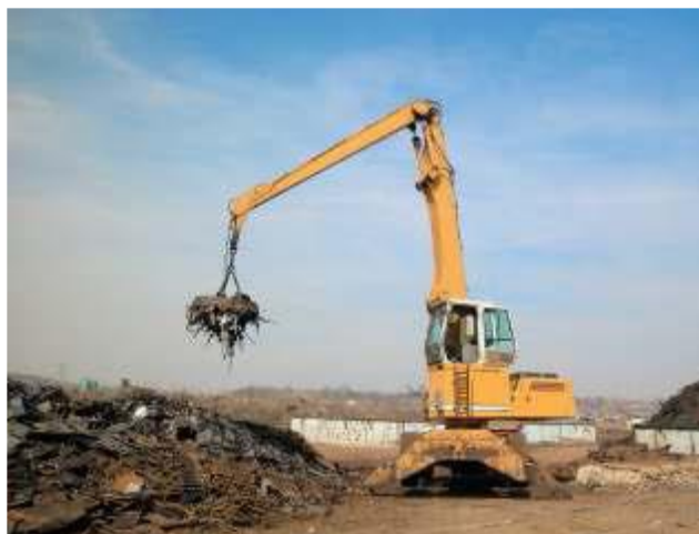
Gambar 5.29 Magnet digunakan untuk memisahkan benda mengandung besi dan baja dalam tumpukan sampah logam.
