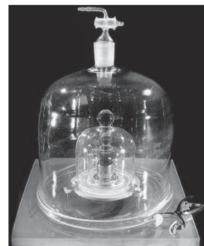
Gambar 1.5 Kilogram Standar yang Terbuat dari Campuran Platina-Iridium Sumber Gambar: http://physics.nist.gov (2008)
