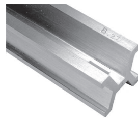
Gambar 1.4 Meter Standar yang Terbuat dari Campuran Platina-Iridium Sumber Gambar: http://museum.nist.gov (2008)
