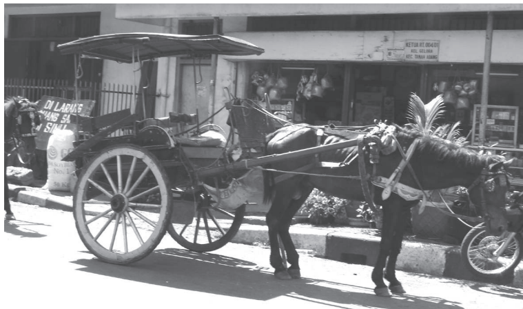
Gambar 5.11 Roda Pedati Dipasang dengan Prinsip Pemuaiian Foto: Dokumentasi Penerbit
